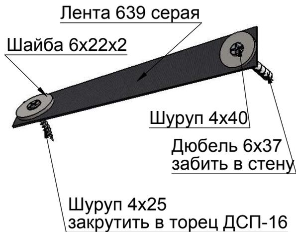
Ленту с дюбелем 6x37, шайбой 6x22x2, шурапами 4x40 и 4x25 использовать для фиксирования с обратной стороны изделия у стены в целях защиты от опракидывания.
